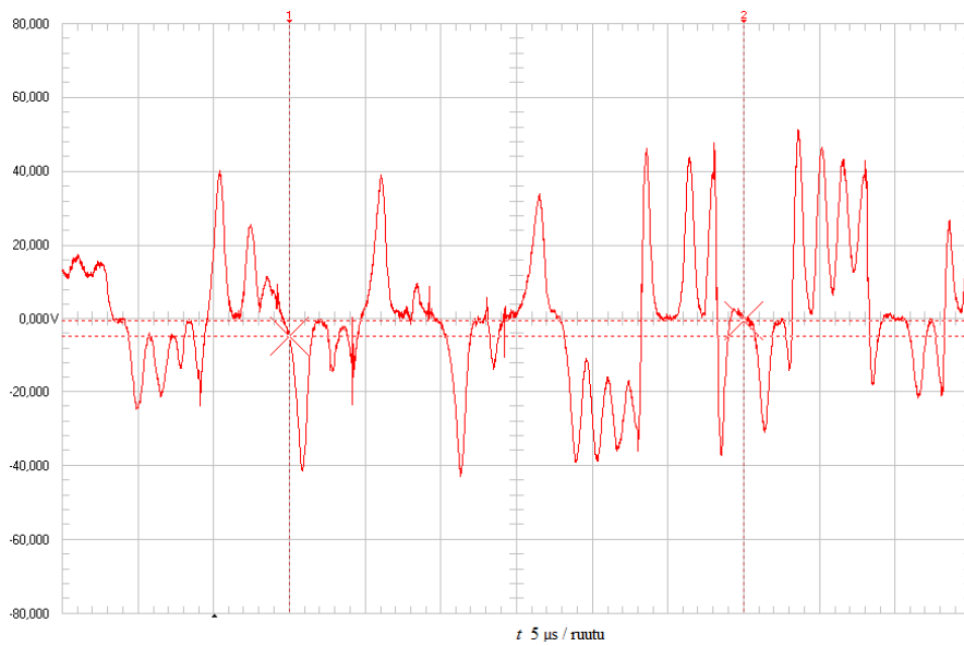
Kuva 27. Ension jännite, kun resonanssikonvertteria syötetään 270 V DC jännitteellä. Kuva on otettu erilaisesta kuormitusilanteesta (referenssi ylittää nollakohtan ja vaihtaa polariteettia), kuin kuva 26. Jännite on skaalattu 10/95.
